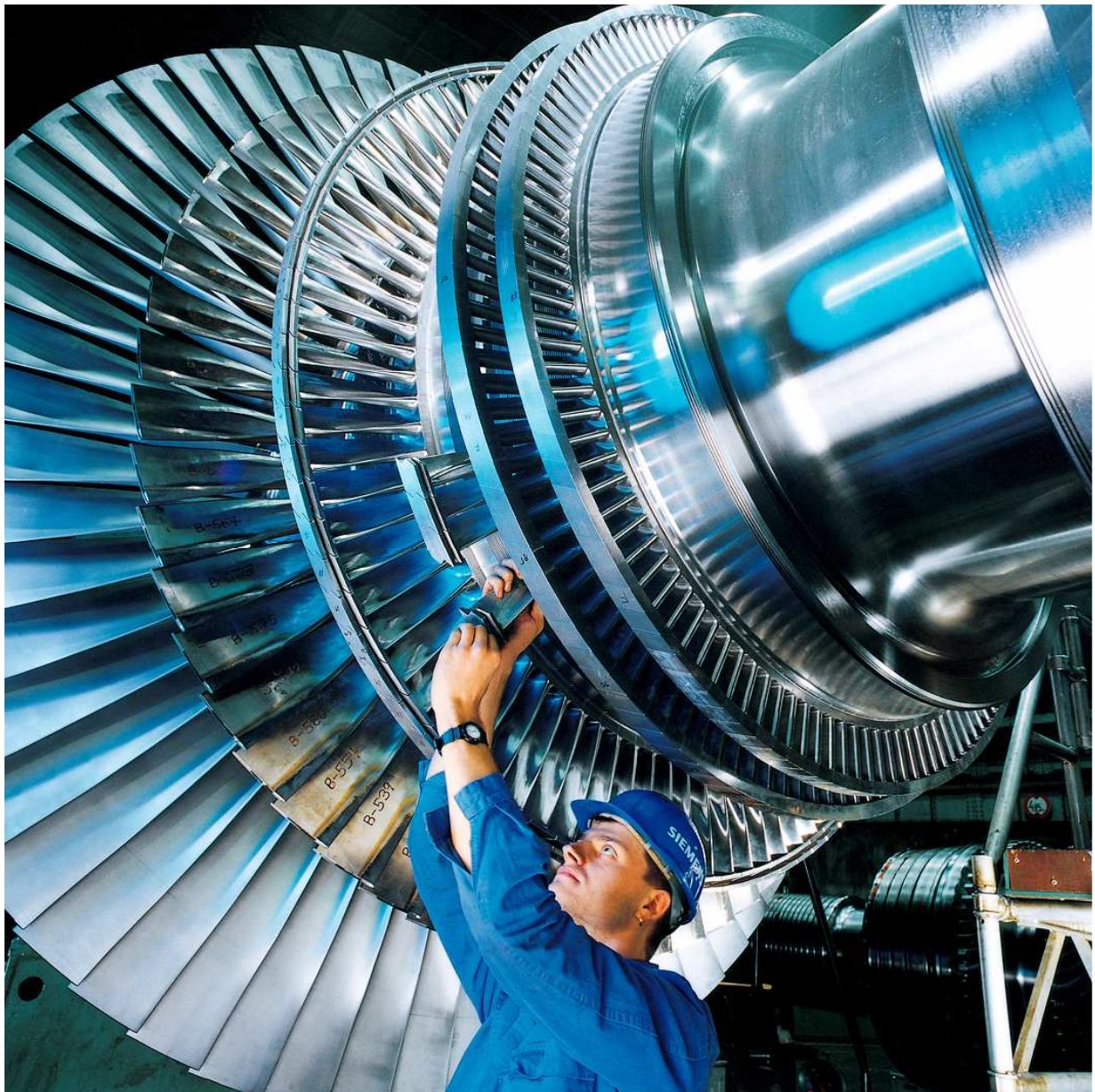
Figure 5-11 : Turbine en cours de montage
