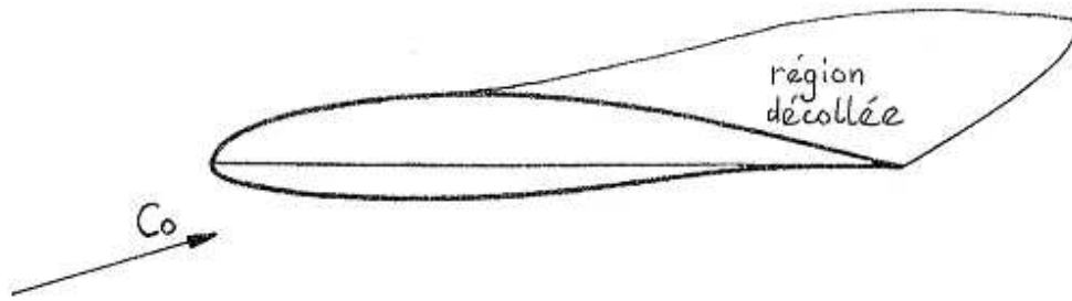
Figure 23 : Décollement à l'extrados du profil. [Réf 230].
