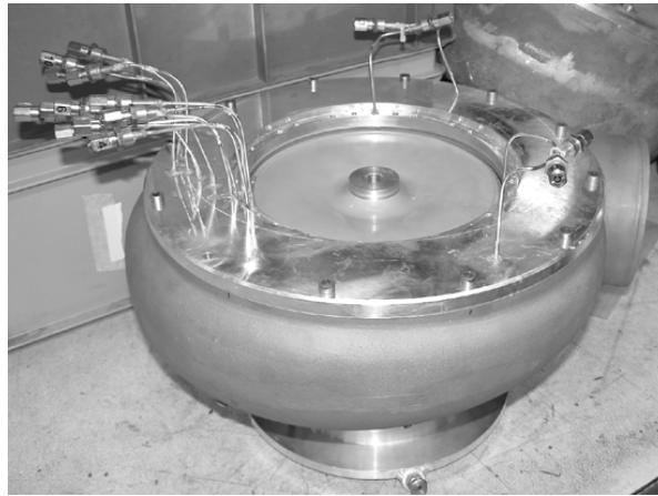
Figure 6.5: Sondes de pression statique sur le flasque arrière du diffuseur.
