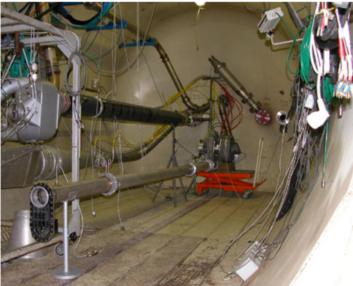
Figure 6.3: Vue d'ensemble de la machine prototype placée dans le caisson d'altitude. La machine est au fond du caisson, au centre de l'image. Le compresseur est sur la gauche et la turbine sur la droite.
